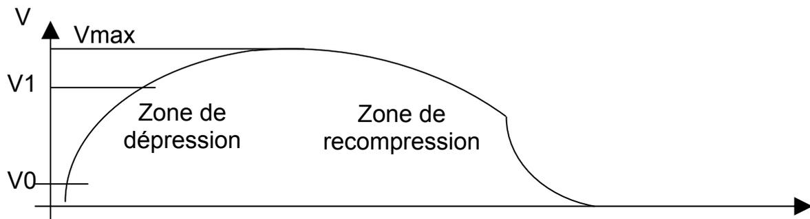
En fait, la couche limite devient de plus en plus « fragile » au fur et à mesure que la zone de recompression est rapide (forte courbure). Il suffit d'une petite aspérité pour qu'elle se décolle avant la zone de décollement naturel. D'où encore une fois l'avantage de soigner les états de surface.
